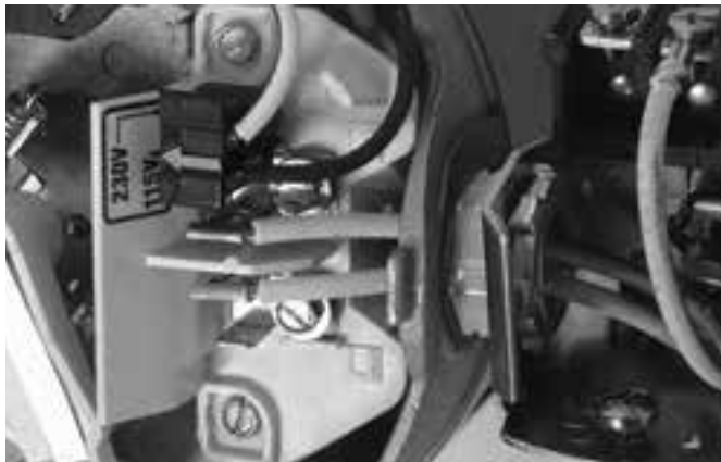
Figura 7 - Tensión configurada para 115 V, tipo ficha.
