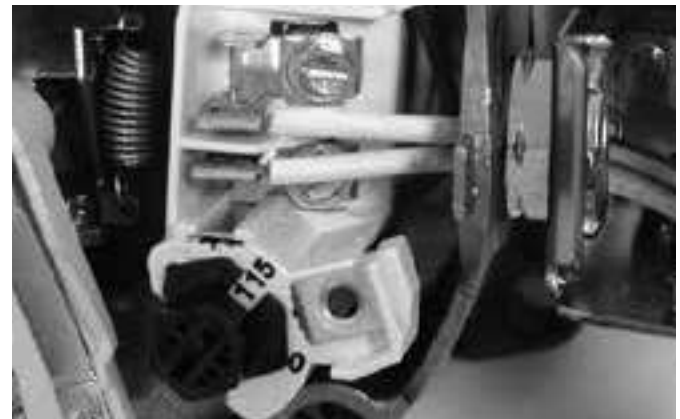
Figura 9 - Tensión configurada para 115 V, tipo cuadrante.
